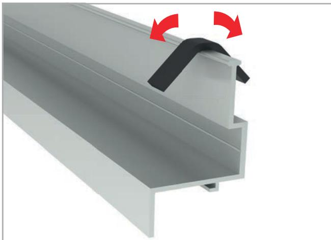
Los segmentos de junta EPDM deben situarse en la parte superior del perfil Z envolviendo su cabeza por ambas caras. El tamaño recomendado de los segmentos de junta es de 60 mm.
