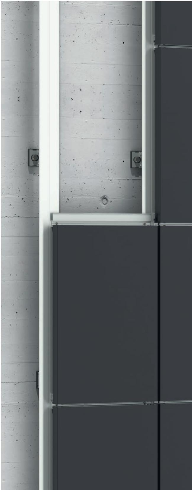
El **STB-T-SZ** es un sistema kit a base de bandejas procedentes de **panel composite STACBOND® para montaje de fachadas ventiladas**. Es un sistema machihembrado de fijación oculta, versátil y de rápido montaje diseñado especialmente para desarrollar fachadas con modulación horizontal con predominio de partes ciegas y/o poca superficie de huecos o huecos lineales.
