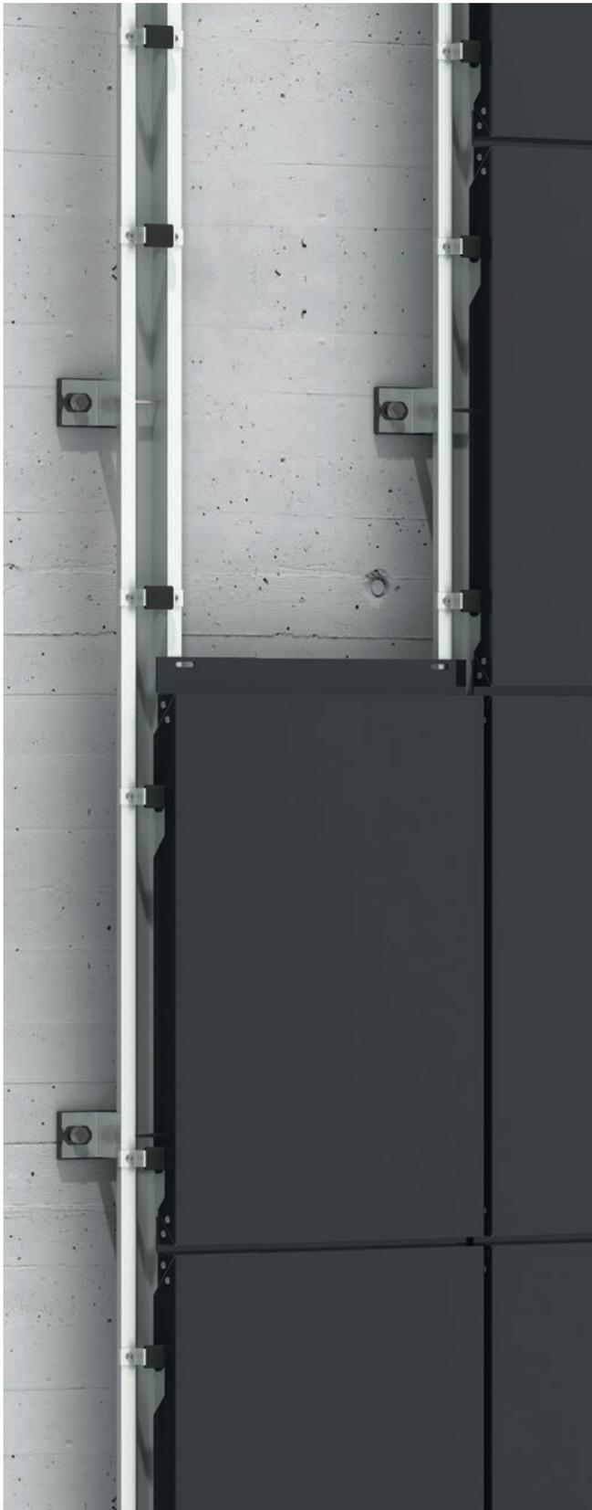
El **STB-CH** es un sistema kit a base de bandejas colgadas procedentes de **panel composite STACBOND® para montaje de fachadas ventiladas**. Es un sistema de fijación oculta, versátil y de rápido montaje, en el cual las modulaciones de las bandejas pueden ser tanto horizontales como verticales. El sistema STB-CH cumple con todos los requisitos para poder ejecutar los recubrimientos arquitectónicos más vanguardistas.
