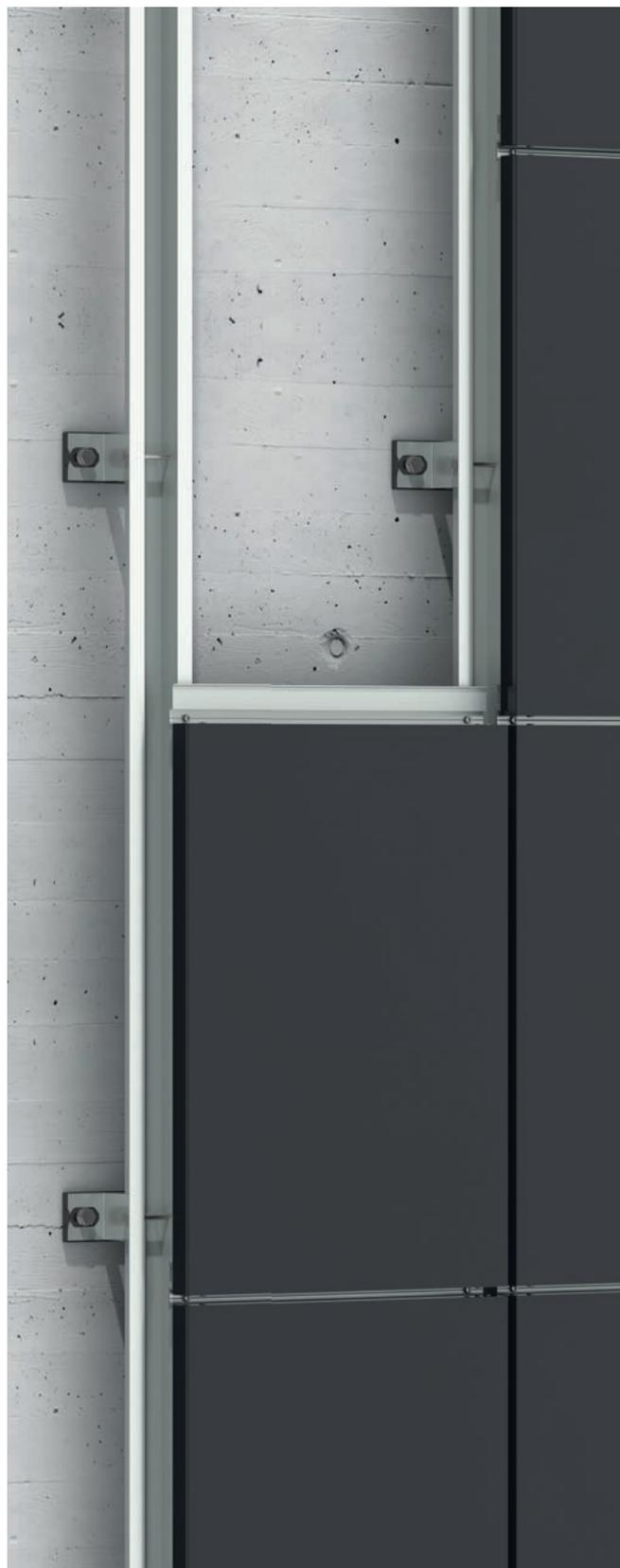
El **STB-SZ** es un sistema kit a base de bandejas procedentes de **panel composite STACBOND® para montaje de fachadas ventiladas**. Es un sistema machihembrado de fijación oculta, versátil y de rápido montaje diseñado especialmente para desarrollar fachadas con modulación horizontal con predominio de partes ciegas y/o poca superficie de huecos o huecos lineales.
