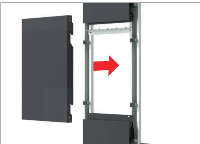
5. Colocación de la nueva bandeja de panel composite **STACBOND**<sup>®</sup>, con bota de cuelgue especial de 9 mm y piezas de refuerzo de cuelgue.
